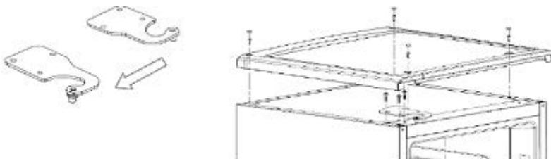
7. Вывинтив винты ручки, закрепите ее на противоположной стороне. Снимите колпачки с боковины дверцы, вкрутите винты в отверстия, указанные ниже. Вставьте колпачки в открывшиеся отверстия с другой стороны.
