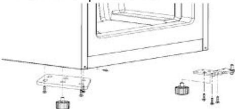
5. Извлеките ось из петли дверцы и вставьте ее с другой стороны петли. Затем привинтите петлю дверцы с другой стороны изделия, после чего привинтите отдельный кронштейн ножек также на противоположной стороне. Снова привинтите обе ножки.
