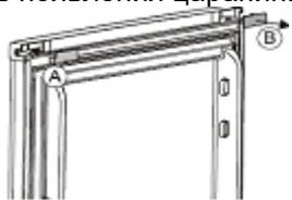
4. Наклоните изделие немного назад и зафиксируйте в этом положении. Отвинтите обе ножки и снимите петлю дверцы вместе с ее осью. Отвинтите кронштейны ножек.
